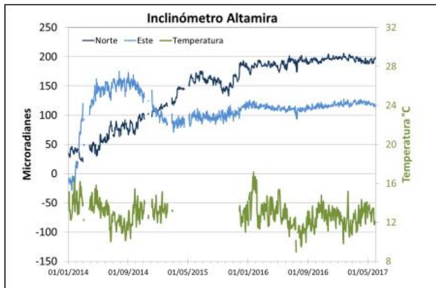
**Figura 72.** Componentes de inclinación Norte y Este, temperatura del inclinómetro electrónico Altamira, instalado en el límite entre los volcanes Doña Juana y Las Ánimas, para el periodo comprendido entre enero de 2014 y mayo de 2017.
