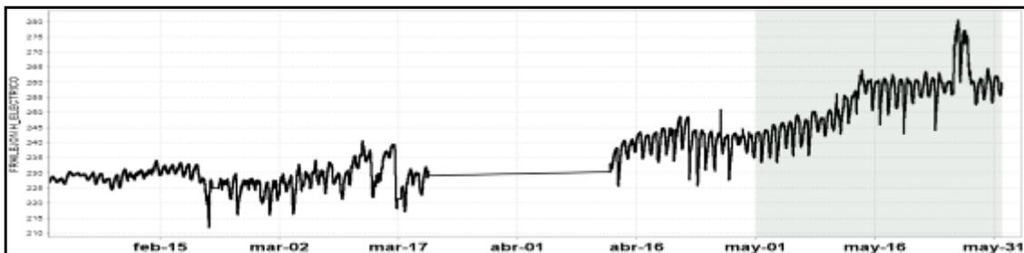
**Figura 33.** Variaciones de la componente horizontal del campo eléctrico en la estación Frailejón, perteneciente a la red de monitoreo del volcán Galeras, para el periodo comprendido entre febrero y mayo de 2017. La escala de medición del campo eléctrico en mV.
